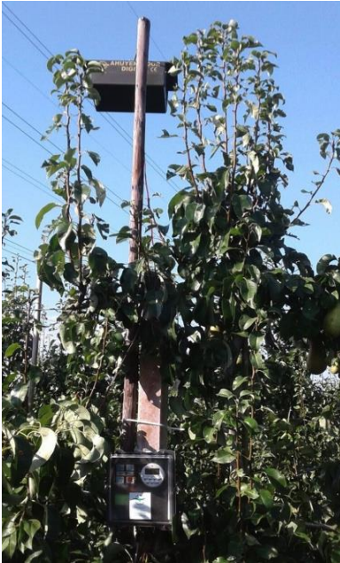
Figuur 2.3 De opstelling van de Alcetsound zoals die in het proefperceel staat. Bovenaan hangt een van de twee geluidsboxen en onderaan hangt de versterker/besturingsunit.
