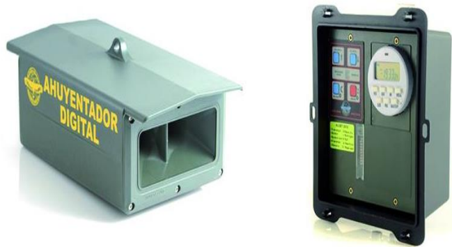
Figuur 2.1. Het Alcetsoundsysteem. Links de geluidbox waar het geluid uit twee kanten de box verlaat. Rechts het besturingskastje waarmee de gebruiker de instellingen kan aanpassen. Rechtsboven in het besturingskastje zit de (witte ronde) tijds klok, hiermee kunnen de intervallen aangegeven worden. Onderaan het kastje zitten de dipswitches waarmee ingesteld kan worden welke geluiden aan en uit staan.
